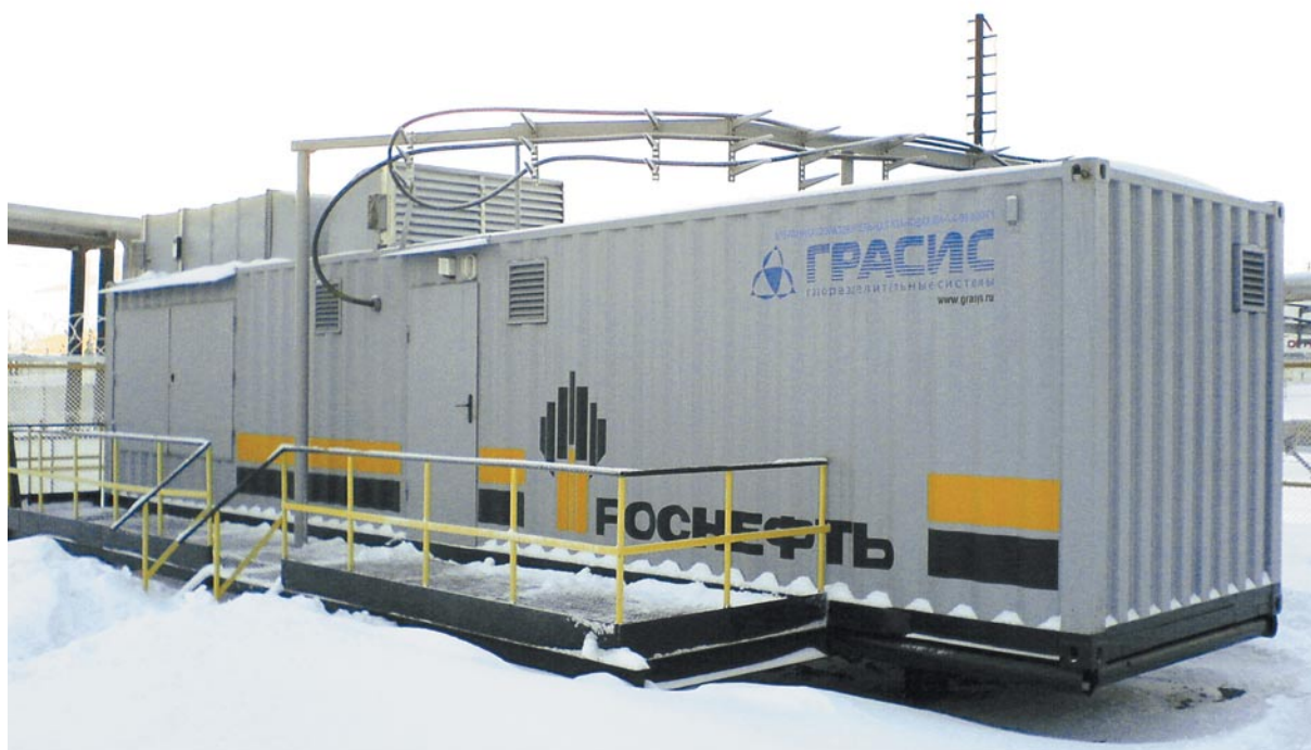
Заказчик — ОАО «НК «Роснефть». Производительность — 250 нм 3 /ч, чистота азота — 99%.
